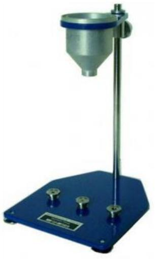
За величину условной вязкости ( $X$ ) в секундах принимают среднее арифметическое значение трех параллельных определений времени истечения ( $T$ ) испытуемого материала и вычисляют по формуле:
